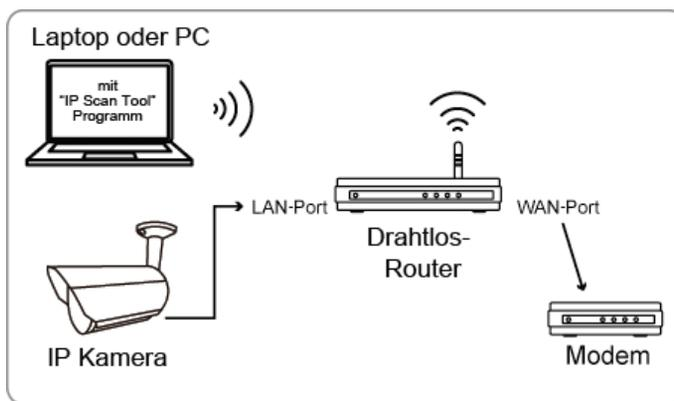
→ Über RJ45 Netzkabel angeschlossene Geräte
