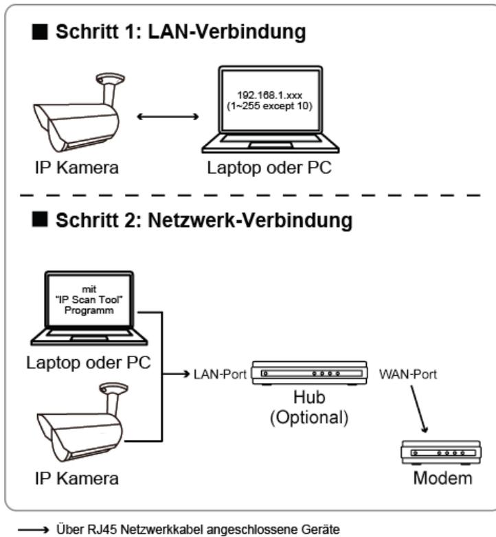
Schritt 1: Trennen Sie Ihren Laptop / PC von Hub oder Modem ab und verbinden Sie über Netzwerkkabel mit der Kamera.
