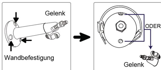
Schritt 3: Befestigen Sie die Kamera mit dem Gelenk an der Halterung.
