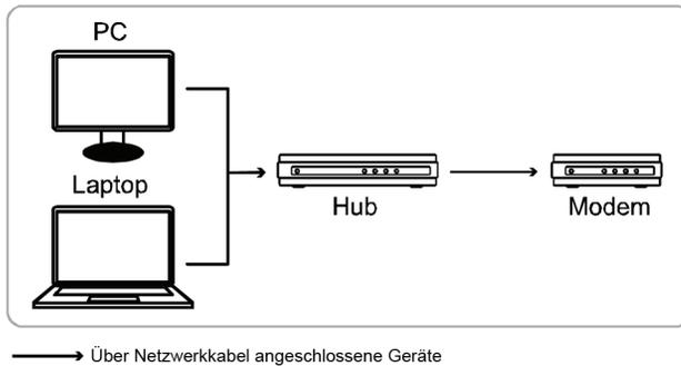
Schließen Sie dann Ihre Netzwerkkamera direkt an Ihrem Drahtlos-Router / Router / Hub / Modem über Netzwerkkabel an und schalten Sie sie ein.
