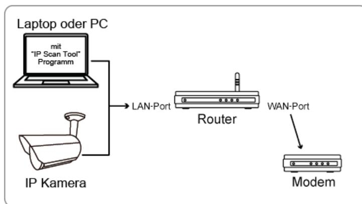
→ Über RJ45 Netzwerkkabel angeschlossene Geräte
